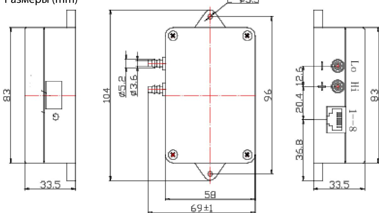
Если существует отклонение нулевой точки из-за положения установки или по другим причинам, его можно сбросить, нажав черную кнопку на задней панели изделия. Питание должно быть включено. В условиях отсутствия перепада давления нажмите кнопку и удерживайте ее более 3 секунд.
